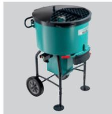
Un modelo robusto para volúmenes de mezcla más grandes (120 litros). Versión robusta con tina de acero. Herramienta de mezcla de 3 brazos para mezcla intensiva; barra de corte para abrir las bolsas; con salida en el suelo y sacudidor para un vaciado fácil; conexión para aspiración de polvo; fácil de limpiar.
