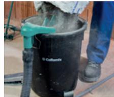
Mezcla baja en polvo, sin carga de polvo durante el llenado y la mezcla.
