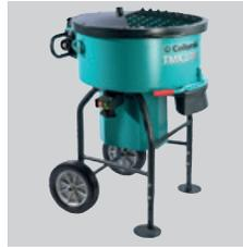
Un práctico todoterreno para multitud de materiales envasados. Versión robusta con tina de acero. Herramienta de mezcla de 3 brazos para mezcla intensiva; barra de corte para abrir las bolsas; con salida en el suelo y sacudidor para un vaciado fácil; conexión para aspiración de polvo; fácil de limpiar.
