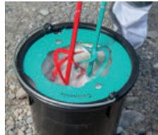
Limpieza del mezclador en cuestión de segundos, garantiza una vida útil prolongada de la herramienta mezcladora. Sumerja el mezclador en el cubo lleno de agua limpia y deje que funcione durante un periodo breve de tiempo. Los cepillos eliminan a fondo los residuos del material.
